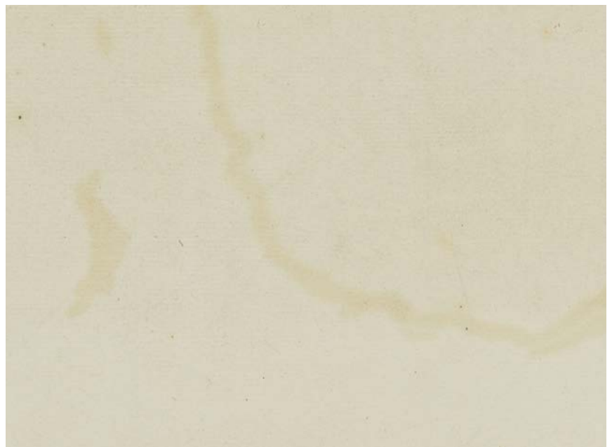
Detail einer Handzeichnung, Vorder- und Rückseite (KSW/Museen GHZ/KS 103): Die Vergilbung der mit grünspanhaltigen Pigmenten kolorierten Bereiche auf der Rückseite weist auf eine chemische Reaktion der Kupferionen mit der Cellulose hin.
