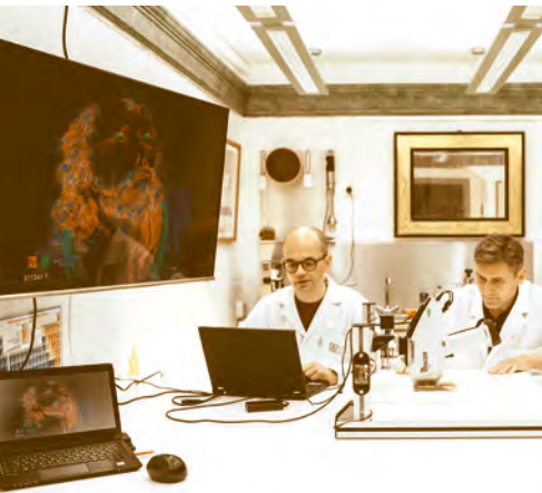
Untersuchung einer Cranach-Zeichnung mithilfe der Röntgenfluoreszenz- analyse
