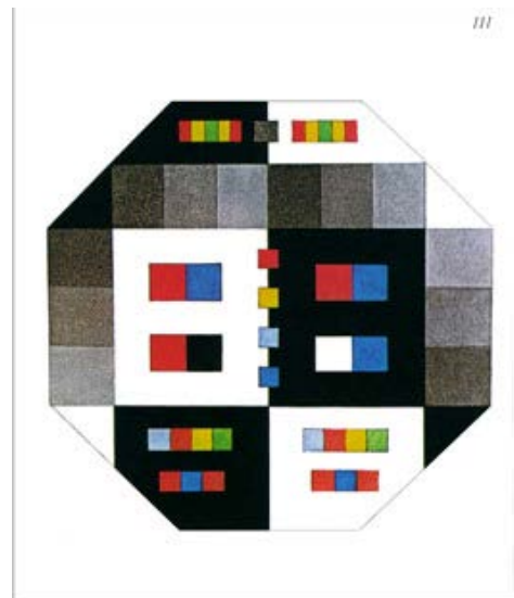
Abb. 4 Die Dritte Tafel dient als Vorlage für subjektive Prismenversuche: Beim Blick durchs Prisma auf diese Tafel werden an den parallel zum Prisma liegenden Grenzen zwischen Hell und Dunkel bzw. verschiedenen Farben die Kantenspektren sichtbar gemacht.
